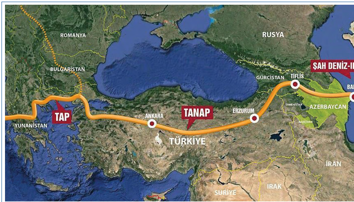
RYS. 37. PRZEBIEG RUROCIĄGÓW TANAP I TAP – POŁUDNIOWY KORYTARZ GAZOWY
